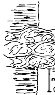
Fig. 66. Barre gréseuse sujette à une intense déformation hydroplastique, intercalée dans des pélites à nodules ferrugineux.
